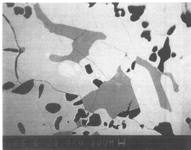
Fig. 10. Alliage \text{Pd}_{57,55}\text{Si}_{42,45} recuit 382 h à 800 °C. Phase claire: \text{Pd}_3\text{Si} et phase noire Si formés lors de la décomposition eutectoïde des cristaux gris \text{PdSi} en dessous de 888 °C. Cette réaction est soumise à un mécanisme de germination qui a épargné certains domaines de \text{PdSi} et rendu possible leur identification. Les fentes sont provoquées par une importante augmentation de volume pendant la transformation (+7%).
